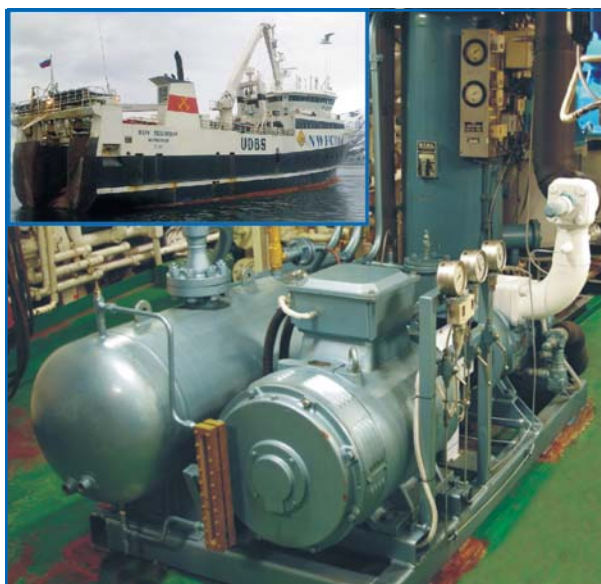
Компрессорный агрегат COOLTECH для корабельной системы охлаждения и заморозки морепродуктов
