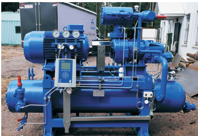
Рис. 1. Применение контроллера UNISAB III SABROE на агрегатах «Култек»
