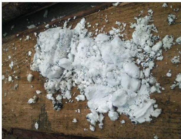
Пример парафинизации масла из-за неправильной организации маслоотделителя
